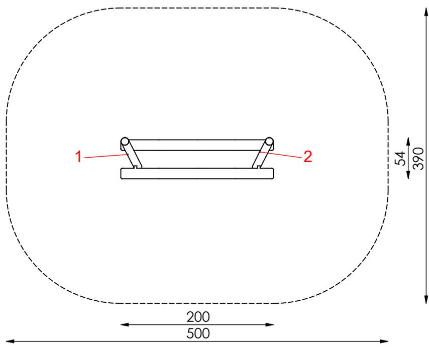
Das Gerät wird als eine Sitzgelegenheit gewertet. Deshalb ist der Einbau auch ohne falldämpfenden Untergrund gestattet !
