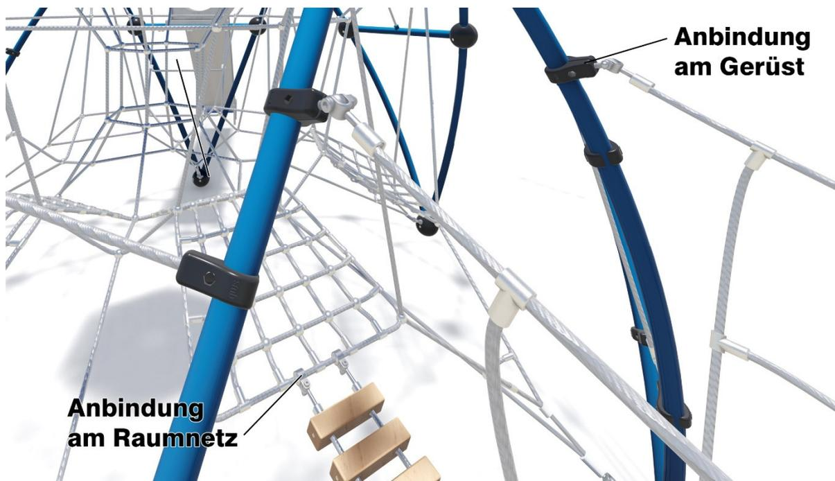
Abb. 19 – Stegbrücke – Anbindung am Gerüst
