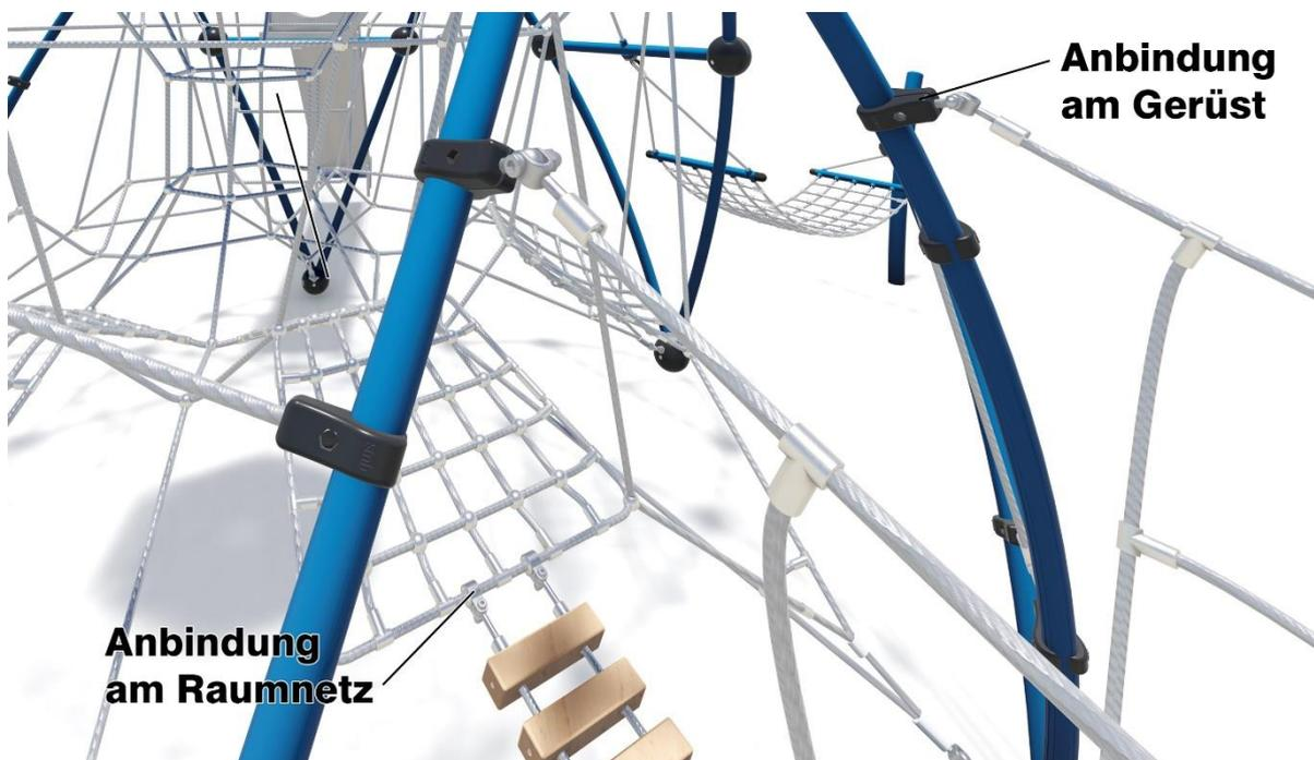
**Abb. 23 – Stegbrücke – Anbindung am Gerüst**
